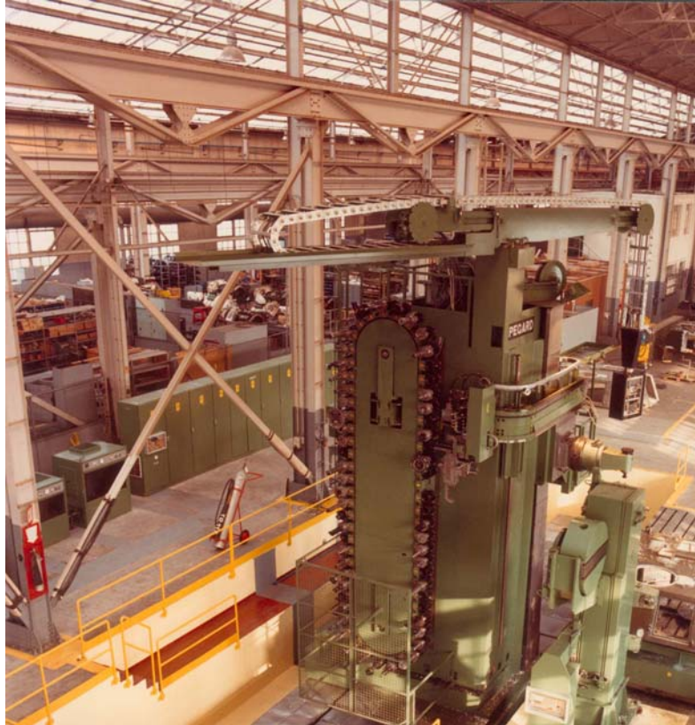
Preciram 4 – changeur d'outils à chaîne – pick-up avec appareils à fraiser
